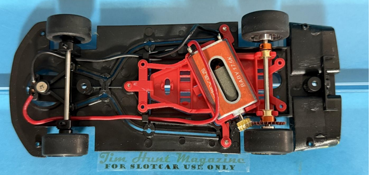
Anglewinder Longcan, max. 17500 Touren. Antriebseinheit über drei/ fünf Dome vom Chassis entkoppelt einstellbar. L-Kiel und alle Komponenten verschraubt.
