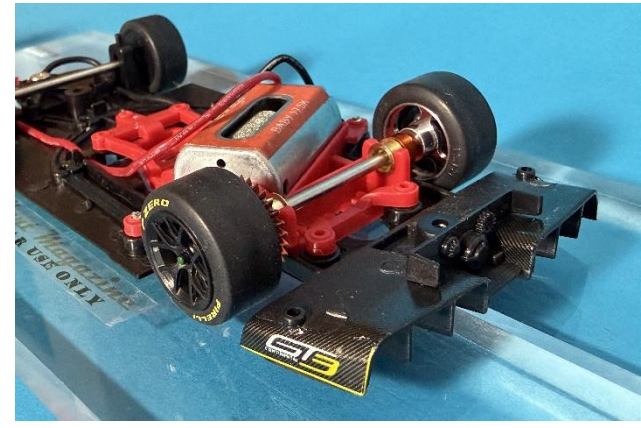
Messingradlager, Spur einstellbar. Höhe der Vorderachse auch. Präzise: Metallgetriebe
