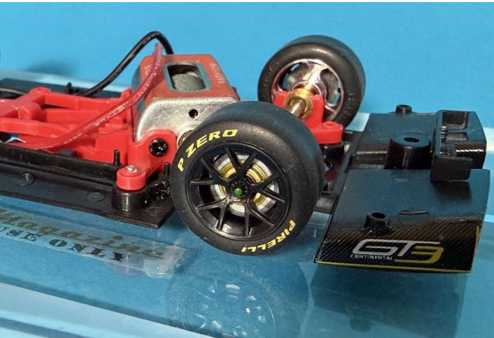
Anglewinder Longcan, max. 17500 Touren. Antriebseinheit über drei/ fünf Dome vom Chassis entkoppelt einstellbar. L-Kiel und alle Komponenten verschraubt.
