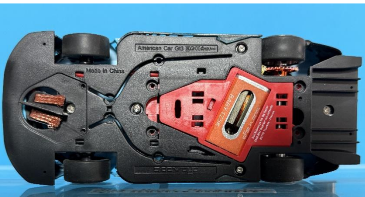
Fahrwerk über Schrauben von unten einstellbar.
